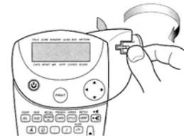
Reinigen Sie die Klinge des Druckkopfes regelmäßig mit einem alkoholgetränkten Wattestäbchen. Verwenden Sie ausschließlich Alkohol (untere Abbildung Nr.2).
