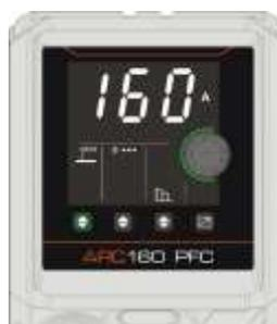
Mit dem Drehknopf können die Parameter Schweißstrom, Heißstartstrom und Lichtbogenkraft eingestellt werden.
