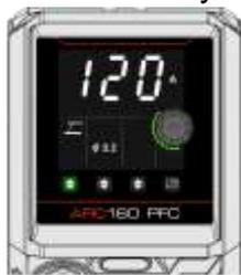
Nach Auswahl des Elektrodendurchmessers wählt das System automatisch den Schweißstrom, den Heißstartstrom und die Lichtbogenkraft. Benutzer können den Einstellknopf entsprechend den Schweißanforderungen drehen, um die Schweißstromparameter fein abzustimmen.
