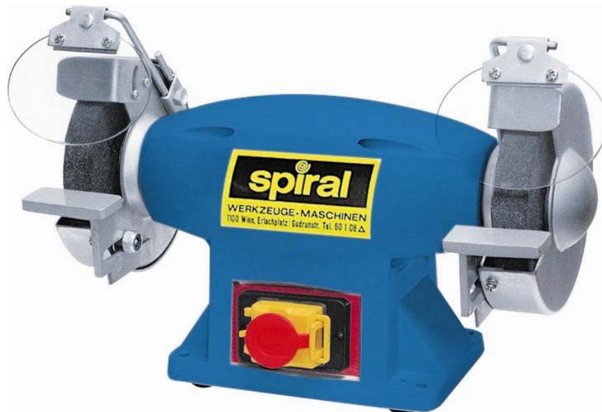
Schleifscheibenabmessungen: 250 x 40 x 32mm
