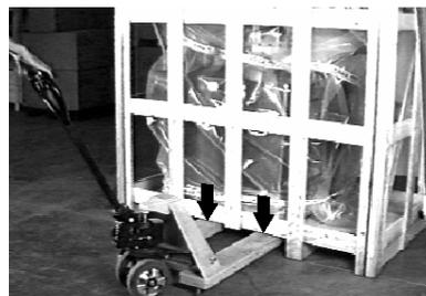
In beiden Fällen ist die Maschine mit einem Handgabelhubwagen zu befördern, wobei die Gabeln gemäß Hinweisen auf dem Holzverschlag, siehe Pfeile oben, eingeführt werden müssen.
