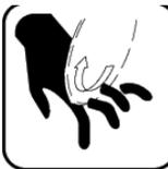
Bei laufender Maschine bzw. arbeitendem Werkzeug niemals mit Händen oder Armen in den Schnittbereich greifen.
