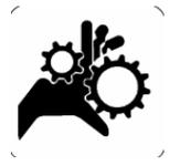
Bei der Arbeit mit der Maschine dürfen keine weiten Kleidungsstücke, übergroße Handschuhe, Armbänder, Ketten oder andere Gegenstände getragen werden, die eine Verfanggefahr darstellen. Lange Haare binden.
