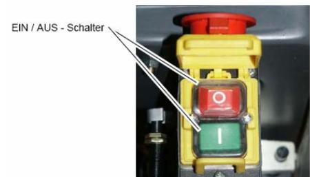
Öffnen Sie die Abdeckkappe des Schalters um die Bohrmaschine einzuschalten. Schließen Sie die Abdeckkappe nach dem Einschalten um die NOT-AUS Funktion zu gewährleisten.
