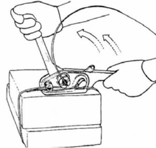
Nach Erreichen der gewünschten Bandspannung schneiden Sie durch Hinunterdrücken des Bandspannhebels das Umreifungsband durch (siehe Abbildung).
