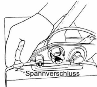
Halten Sie nun den Bandspanner mit der einen Hand, mit der anderen Hand ziehen Sie durch Vorwärts- und Rückwärtsbewegungen des Bandspannhebels das Umreifungsband fest, bis die gewünschte Bandspannung erreicht ist (siehe Abbildung).
